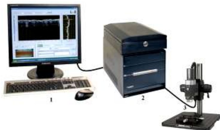
Рис 1. Экспериментальная установка: 1 – ПК; 2 – ОКТ (Spectral Radar OCT System OSP930SR 022); 3 – регистрирующее устройство
